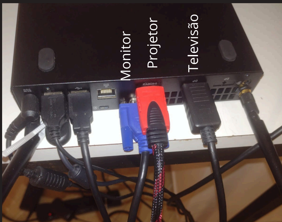
Cabos de vídeo conectados de maneira ideal no computador
